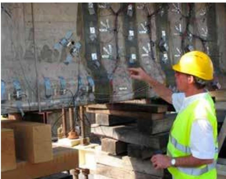
Des capteurs peuvent permettre de surveiller à distance et en temps réel l'état des ouvrages d'art.
