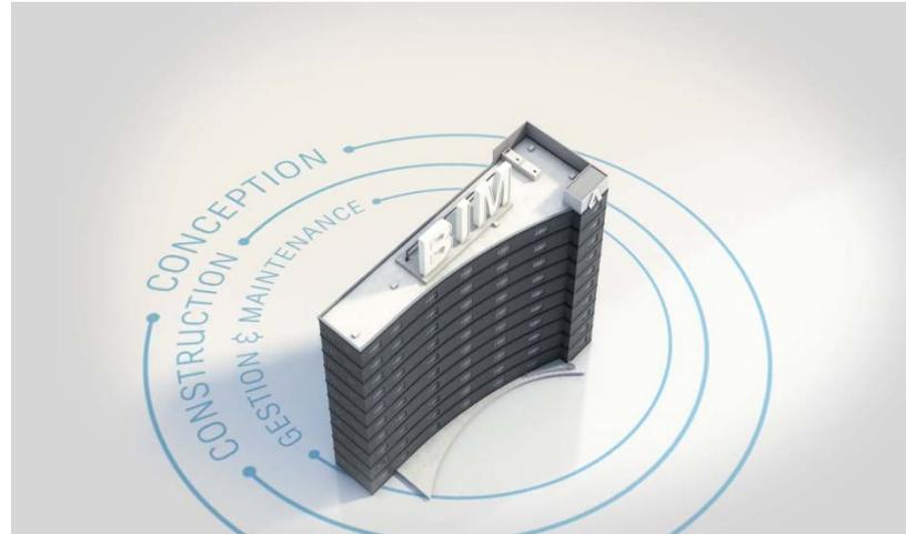
Avec le **B.I.M.** les concepteurs créent des modèles 3D intelligents, renseignés, qui intègrent des informations comprenant des caractéristiques et des propriétés physiques et fonctionnelles des matériaux et éléments qui composent le bâtiment ou les ouvrages.
