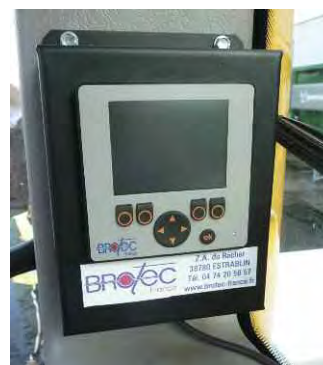
Boîtier d'affichage de la pression en cabine (Brotec)
