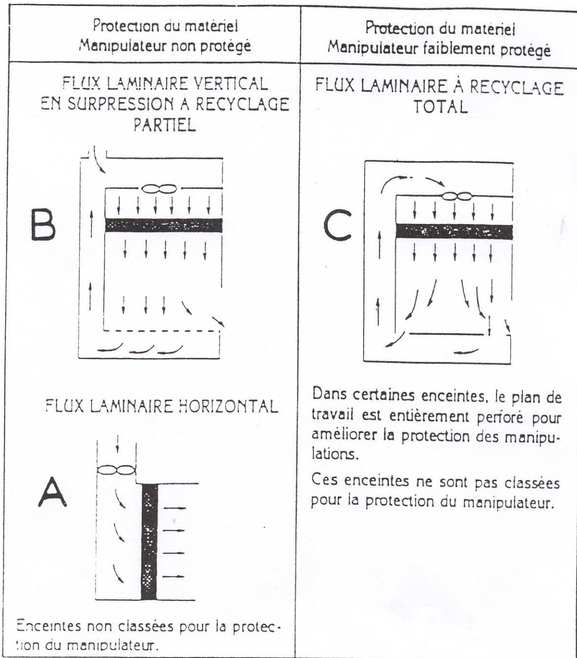
Fig.2. Enceintes non classées pour la protection du manipulateur.
