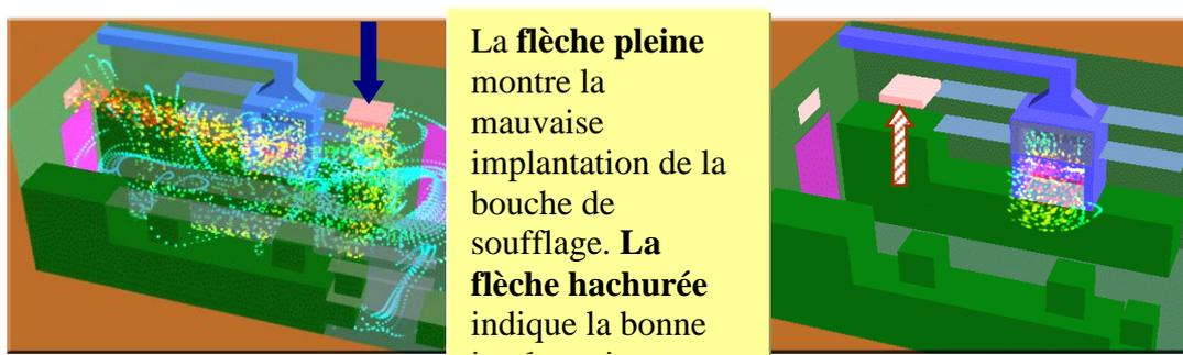
**Figure 1** : Influence de l'implantation des bouches de soufflage sur le fonctionnement d'une sorbonne (d'après étude NIH)
