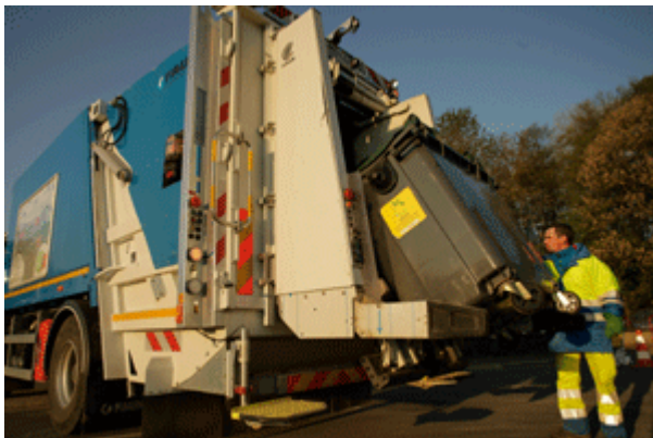
Collecte des conteneurs avec système d'identification
